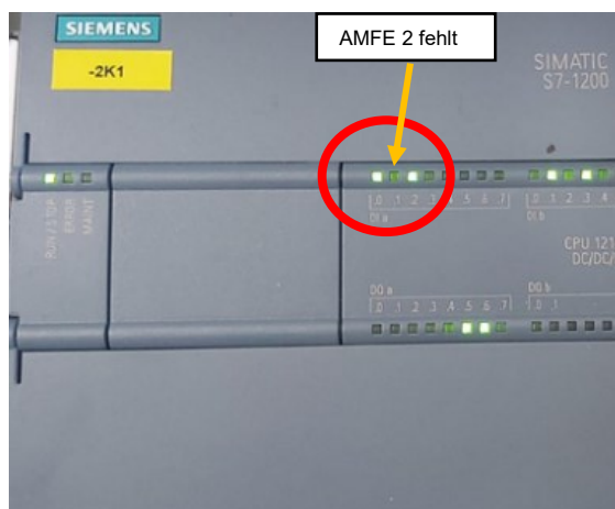
Bild 17 – S7-Steuerung eines Multialert mit 3 AMFEN – AMFE2 meldet nicht zurück
